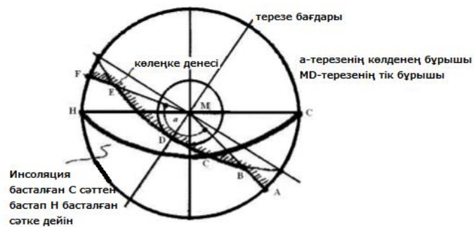
28-сурет. Ғимарат ішіндегі инсоляция уақытын анықтау. Бұл мысал Дунаевтың күн карталарын пайдаланады.
